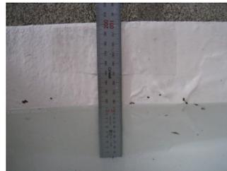
⇒左:2か月経過段階で段ボール箱への浸水・染み跡なし右:未塗布
